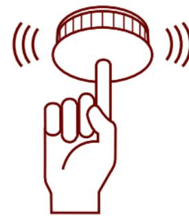
Die Rauchmelder prüfen regelmäßig selbsttätig ihre Betriebsbereitschaft. Um diese Funktion zu überprüfen, sollten Sie alle 7 Tage durch leichtes Drücken der unteren runden Fläche einen kurzen Probealarm auslösen. Mit sanftem Druck auf diesen Sensorbereich können Sie sowohl den Alarm als auch den Hinweiston (Help-Signal) vorübergehend deaktivieren.
